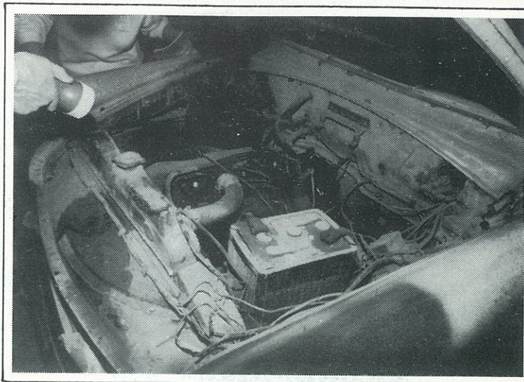
Kíkt undir húddið. Sex strokka "flathead", sést ekkert ryð í innri brettum eða hvalbak.
